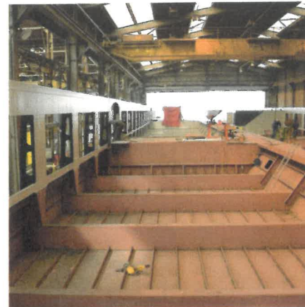
Assemblage de la coque à Dieppe.
